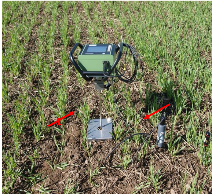
Joonis L5.6. Eijkelkampi penetrologger (1) mulla tihkuse (kõvadus, MPa) koos mahulise niiskuse (2 - TDR,%vol) mõõtmiseks 0 – 10 cm sügavuselt.
