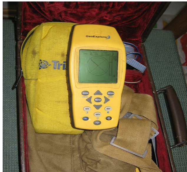
Joonis L5.4. Geoxplorer, mille abil toimus Z-punktide katsekohtades registreerimine
