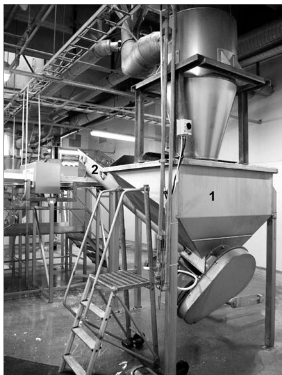
Joonis 37. Toorrasva vastuvõtmine: 1 – vastuvõtupunker; 2 – tigutranspordöör
