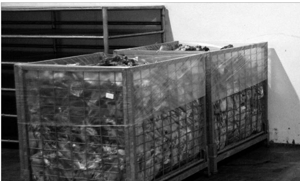
Joonis 17. Seapeade järeljahutamine. Järeljahutamine temperatuurini +3 °C toimub võrkkonteinerites
