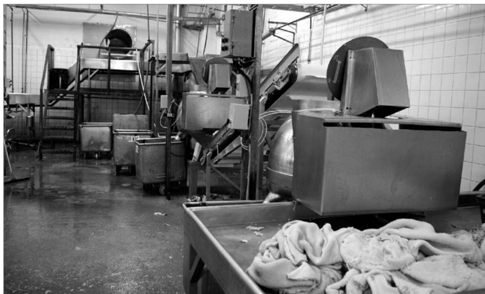
Joonis 24. Veiste vatsade töötlemise liin
