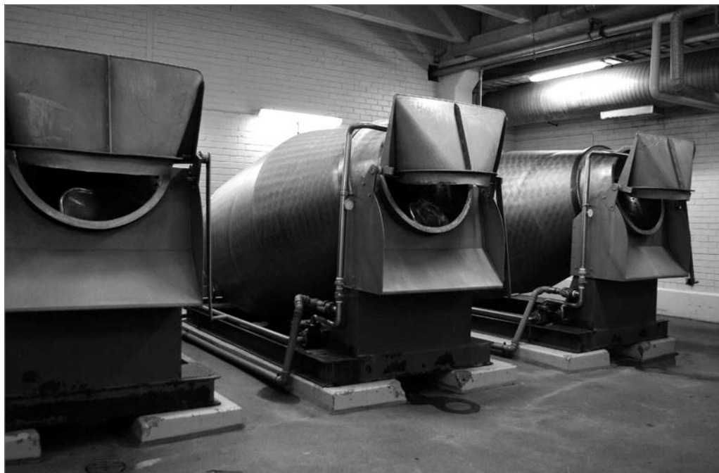
Joonis 70. Nahkade pesemise trumlid
