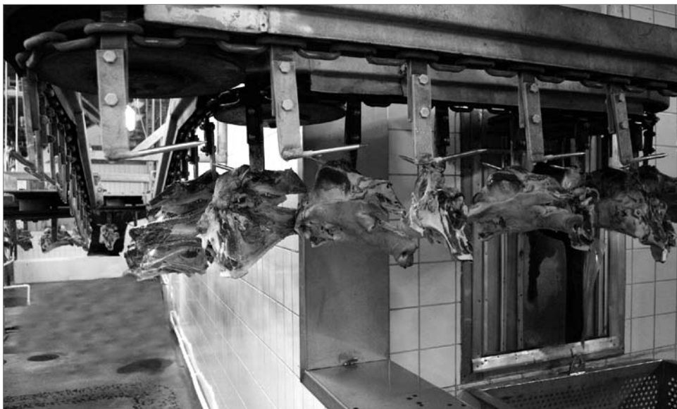
Joonis 16. Seapeade jahutamise liin. Seapead transportitakse liinil läbi ruumi temperatuuril miinus 15 °C, jahutamise aeg 45 minutit
