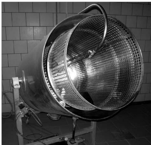
Joonis 21. Tapasaaduste pesemise ja nõrutamise trummel
