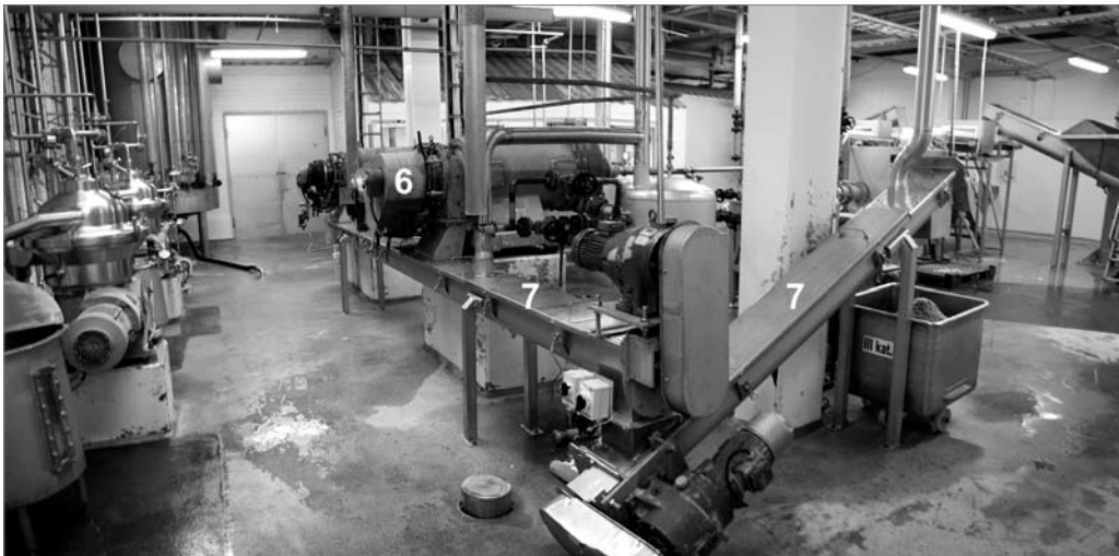
Joonis 39. Kõrnete töötlemine: 6 – dekantertsentrifuug; 7 – tigutransportöör
