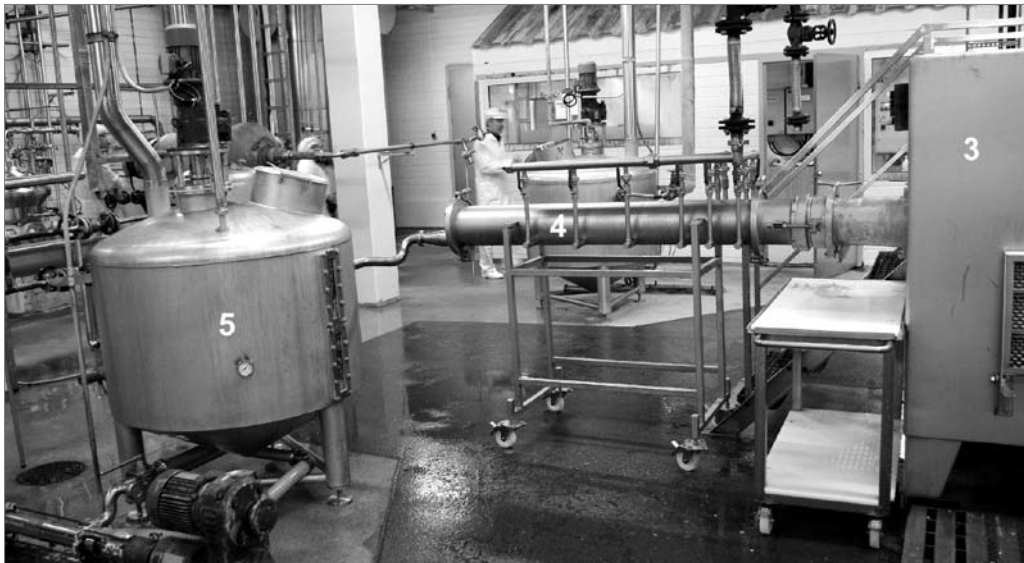
Joonis 38. Toorrasva peenestamine ja sulatamine: 3 – lihahunt; 4 – rasvasulatusaparaat; 5 – rasvasulatuskatel
