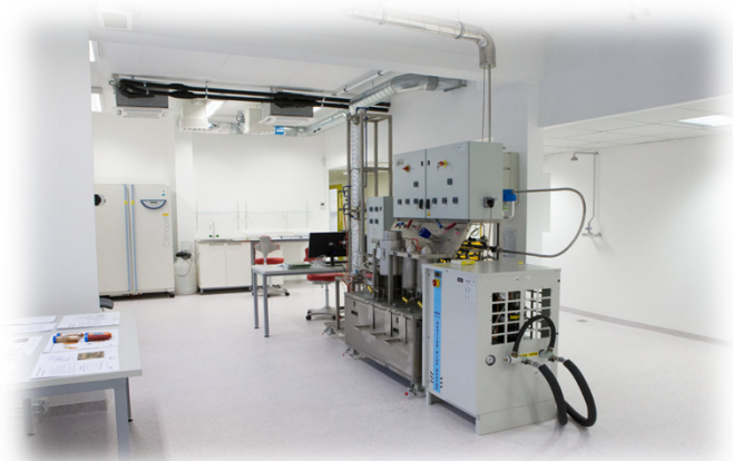
Pilootne superkriitiline süsihappegaasi ekstraktor Pollis
