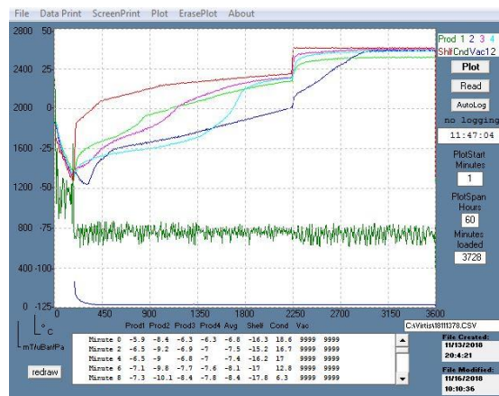
Joonis 4.4 Külmkuivatuskatse nr.2 käiku iseloomustavad parameetrite muutumised
