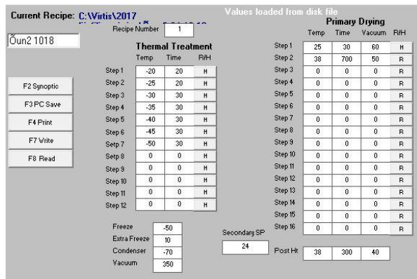
Joonis 4.6 Külmkuivatuskatse nr.3 läbiviimisel kasutatud režiimid
