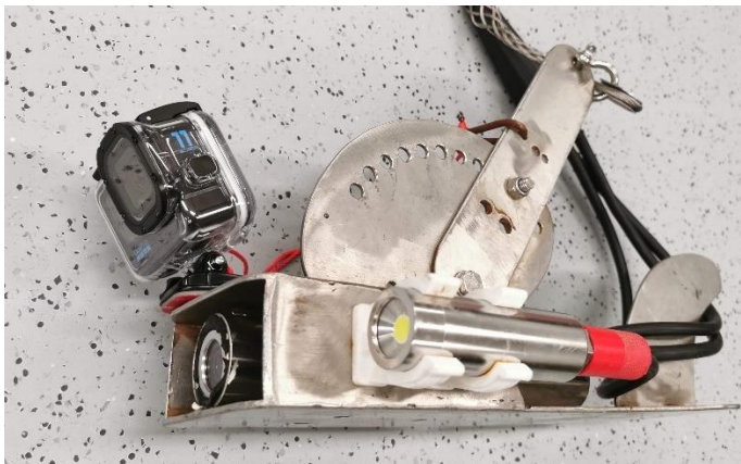
Joonis 3.1.3. GoPro kaamera kinnitatud LH Camera allveevideosüsteemi kaamera raamile.
